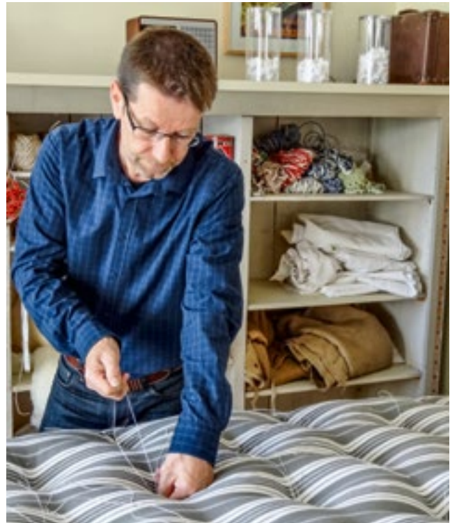
Die Boufettes sorgen dafür, dass die Füllung am richtigen Ort bleibt und sich durch den Gebrauch der Matratze keine Mulden bilden. Hier werden sie noch einmal nachgespannt, anschliessend die Fäden entfernt, dann ist die Matratze bereit zum Ausliefern.
