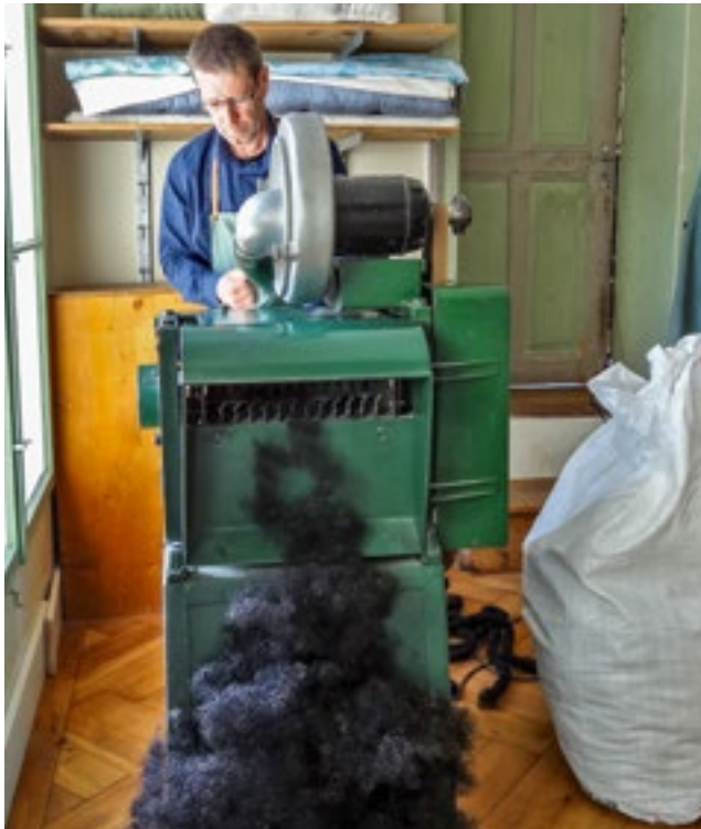
An der Zupmaschine werden die gedrehten Rosshaarstränge aufgezwickelt und so für die Füllung vorbereitet. Wird ein ganzer 13-kg-Sack aufgezupft, ist der gesamte Fussboden der Werkstatt mit Rosshaar bedeckt.
