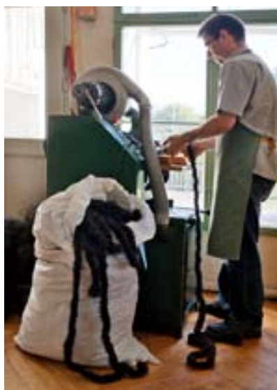
Das Rosshaar wird gezöpft im 13-Kilo-Sack geliefert. Mit einer Maschine rupft Roth das Haar auf.
